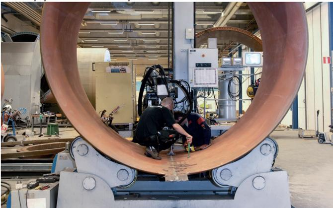
Продольная внутренняя сварка выполняется с помощью комплекта роликовых опор РЕМА серии А и сварочного центра
