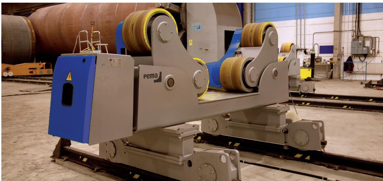
Все роликовые опоры РЕМА могут быть установлены на рельсовые тележки
