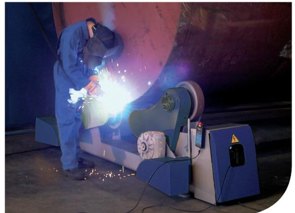
Роликовые опоры РЕМА серии А обеспечивают равномерное распределение веса детали
