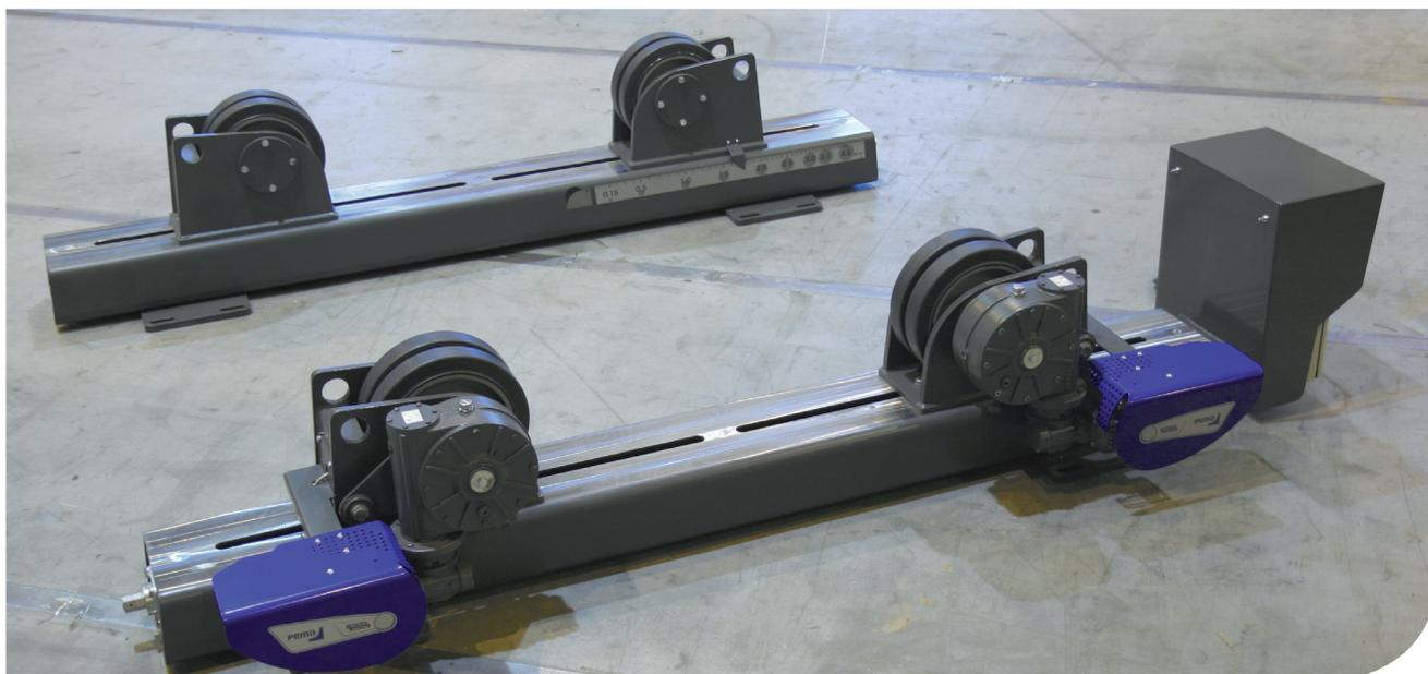
*Комплект роликовых опор РЕМА N12, приводная и холостая секции*
