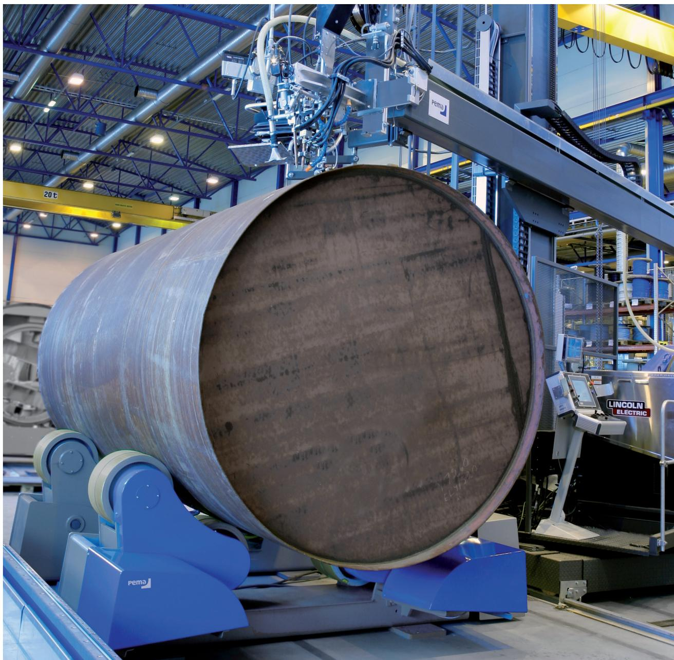
*Роликовые опоры РЕМА со сварочным центром консольного типа РЕМА – комплексное решение для самых ответственных задач по сварке*
